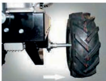
Die linke Achse kann für optimalen Abstand in vier Stufen verstellt werden (25 – 27 – 29 – 31 cm).
