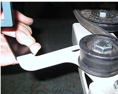
Der Keilriemen wird bei der Montage des Mulchers mit dem Geräteträger und dem AP 90 verbunden und sorgt für den Antrieb der Messerwelle.
