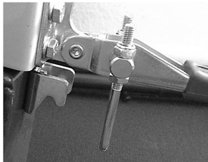
Zum Entriegeln den Hebel nach hinten drücken, bis der Federbügel sich aus dem Haken löst.
