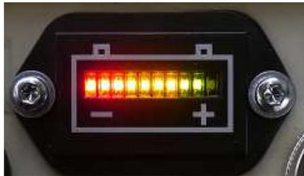
Anzeige des Ladevolumens des Batteriesystems
