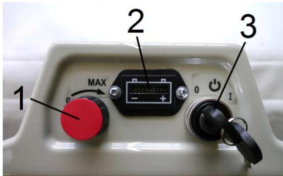
Bedienpult: 1 = Drehzahlregler (Poty)
