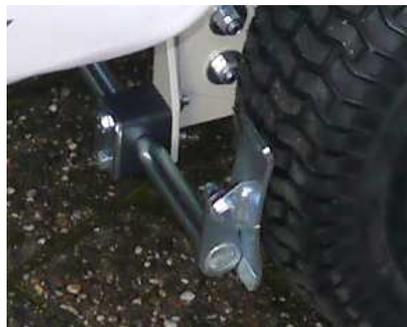
Die Maschine kann mit einer Feststellbremse vor dem Wegrollen gesichert werden. Die Bedienung der Feststellbremse ist an dem linken Haltegriff des Lenkholms angebracht.
