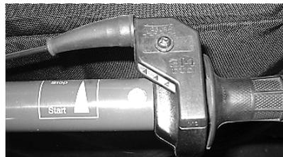
Die Maschine besitzt für den stufenlosen Fahrtrieb einen Drehgriff an der rechten Seite der Lenkstange.
