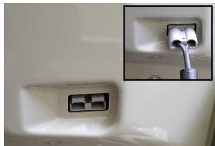
Das Batterieladegerät an eine Steckdose anschließen.
