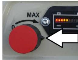
Der stufenlose Fahrtrieb ist erst ab einer höher gedrehten Motordrehzahl möglich.
