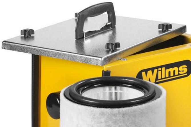
2. Lösen Sie die an der Geräteoberseite befindlichen vier Sternschrauben und heben Sie den Deckel ab.
