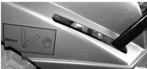
Der Hebel befindet sich hinter dem linken Hinterreifen
