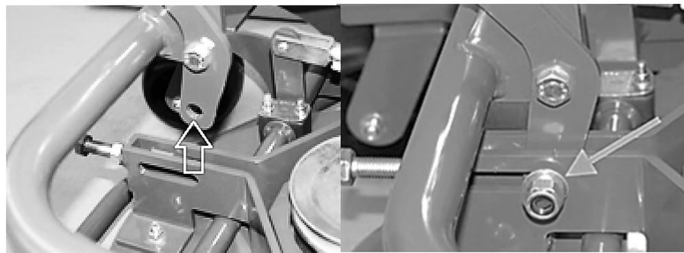
12. Der Hebel des Keilriemenspanners ist auf entspannt eingestellt.
