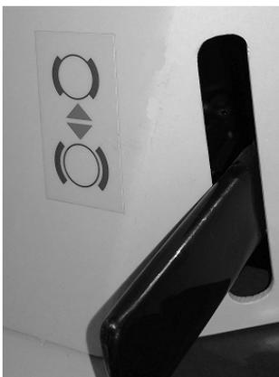
Den Hebel für die Feststellbremse schieben.
