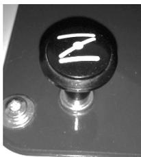
Den Choke vor dem Starten der Maschine ziehen. Nach dem Start wieder nach unten drücken.
