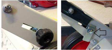
Die untere Griffmutter etwas abdrehen und auf der Innenseite die Verriegelung von dem Ende des Lenkbügels abnehmen und zur Seite drehen.
