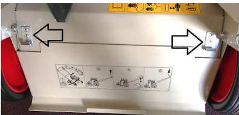
In den Haken an der Rückseite des Vertikutierers kann ein Fangsack eingehängt werden. Die Steinschutz-Klappe vorab anheben, anschließend den Fangsack einhängen.
