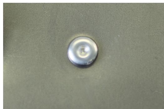
RISULTATO DELLA POSA DI UN RIVETTO FLOW-FORM
