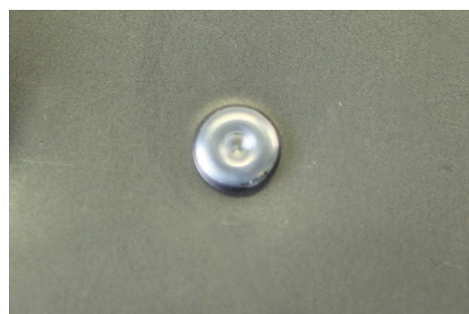
RESULTAAT VAN HET AANBRENGEN VAN FLOW-FORM RIVETS
