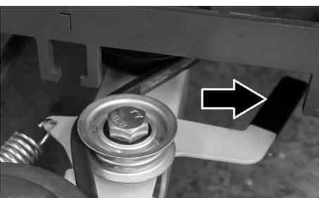
Der Keilriemen wird bei der Montage des Mulchers mit dem Geräteträger und dem AP 90 verbunden und sorgt für den Antrieb der Messerwelle.
