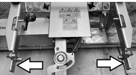
Der AP 90 wird mit seinen Anschlüssen auf der Aufnahme des Geräteträgers TOURNO aufgelegt.
