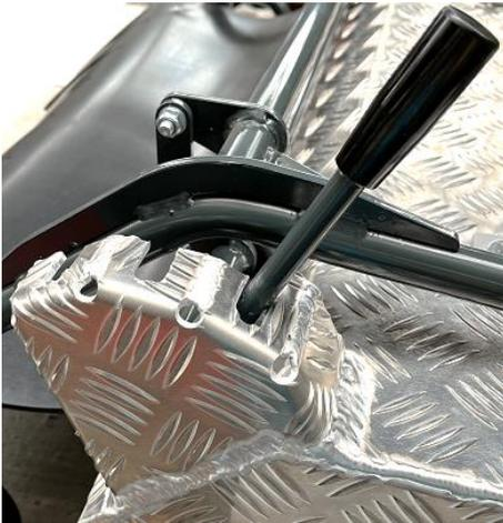
Die Mähhöhe des Mulchmähers lässt sich mit dem Verstellhebel in drei Stufen einstellen. Den Verstellhebel etwas nach außen drücken und bei der gewünschten Mähhöhe wieder einrasten lassen.
