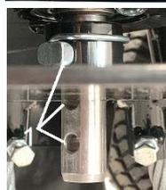
Die Höhe der Drahtzöpfe zum Untergrund lässt sich an den drei Bohrungen (1) an der Bürstenwelle einstellen. Die Spitzen der Drahtzöpfe sollten für die optimale Einstellung gerade so den Boden berühren. Eine zu tiefe Einstellung der Bürste führt zu einer Überbelastung des Antriebes und zu einem unnötigen Verschleiß der Drahtzöpfe.
