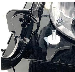
Die Sterngriffschraube rausdrehen. Mit den drei vorgegebenen Bohrlöchern kann die Lenkbügel-Höhe gewählt werden. Die Sterngriffschraube in der gewünschten Höhe wieder eindrehen.
