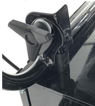
Die Seitenklappe vor dieser Einstellung schließen. Die Sterngriffschraube herausdrehen. Den Lenkbügel nun langsam in Richtung der Motorhaube klappen. Die Bowdenzüge (Kabel) dabei rechts und links vom Motorblock halten.
