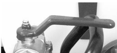
Der Hebel ist zum Öffnen und Schließen des Wasserablaufs.
