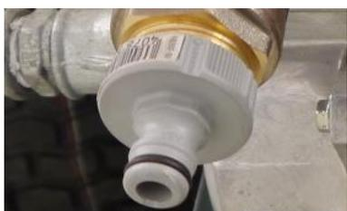
Der Gartenschlauch kann hier an den Wassertank angeschlossen werden.
