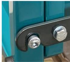
Die Heckklappe beidseitig in die Halterung (1) einlegen und mit dem Verschlusshebel (2) befestigen.
