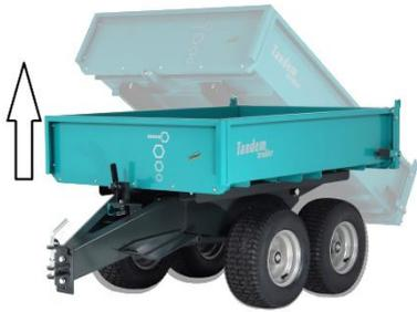
Die Ladefläche lässt sich nach der Entriegelung der Kippfunktion durch pumpen mit dem Pedal der Fußpumpe (b) anheben.
