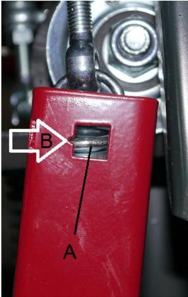
Die Keilriemenspannung des Kupplungsriemens sollte regelmäßig kontrolliert werden.
