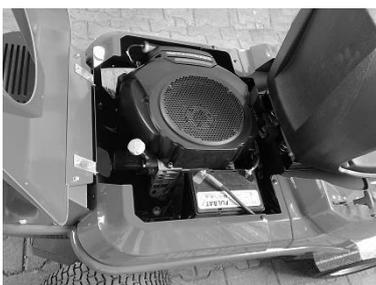
Die Motorhaube lässt sich für Wartungsarbeiten öffnen. Der Drehverschluss zum Entriegeln der Motorhaube befindet sich unter dem Fahrersitz.
