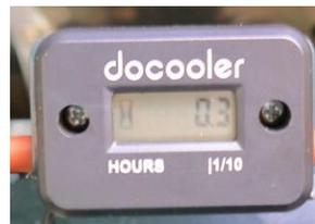
Für die Kontrolle der **Wartungszeiten** ist ein **Stundenzähler** angebracht worden. Sie können die **Fahrzeiten** auf dem unter dem **Fahrersitz** angebrachten **Stundenzähler** ablesen.
