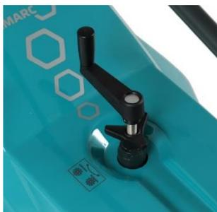
Mit der Kurbel wird über die Stützraideinstellung die Höhe der Kehrbürsten verändert. Die Borsten der Kehrbürsten sollten für die optimale Einstellung gerade so den Boden berühren. Eine zu tiefe Einstellung der Kehrbürste führt zu einer Überbelastung der Antriebe und zu einem unnötigen Verschleiß der Bürsten.
