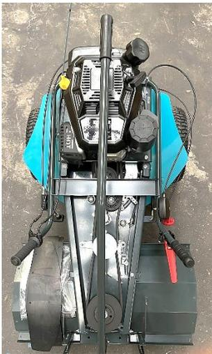
Der Lenkbügel lässt sich für den Transport und platzsparender Aufbewahrung umklappen. Außerdem kann er für ein bequemes Arbeiten in der Höhe eingestellt werden.
