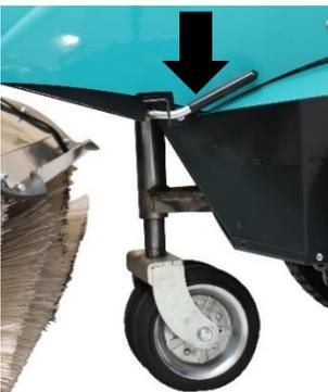
Das Stützrad kann durch die Verstellung des Hebels festgesetzt werden. Mit einem festgesetzten Stützrad ist das Arbeiten mit einer schräg stehenden Bürste leichter. Hierbei ist die Fahrtrichtung der Kehrmachine trotz der schräg stehenden Bürsten geradeaus.
