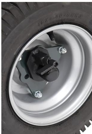
Mit der manuellen Radkupplung kann von Motorantrieb auf Fortbewegung per Hand gewechselt werden. Für den Wechsel muss der Mitnehmer (Hebel) am Antriebsrad gedreht werden.
