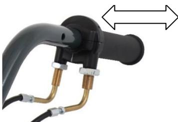
Mit dem rechten Drehgriff kann der Fahrtrieb betätigt werden.
