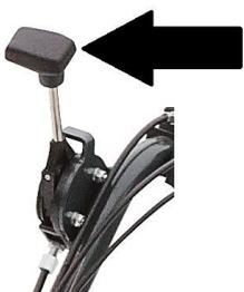
Die Bürstendrehzahl lässt sich mit dem Regulierungshebel einstellen. Die Bürstendrehzahl ist von langsam bis schnell stufenlos einstellbar.
