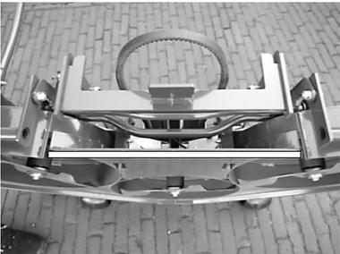
Mähwerk mit geöffneter Mulchklappe.
