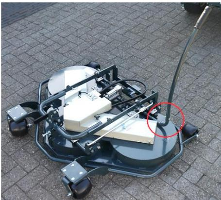
1. Die beiliegende obere Hebelstange auf den unteren Abschnitt aufsetzen. Die Bohrungen müssen fluchten.
