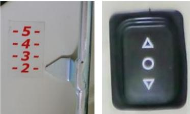
Die Mähhöhe wird über das auf dem Geräteträger befindliche Bedienpult eingestellt. Mit dem Schalter können Sie das Mähwerk elektrisch hoch und herunterfahren, und so immer der gewünschten Rasenlänge anpassen.
