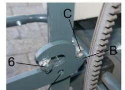
4. Jetzt das Mähwerk herunterklappen und gleichzeitig zum Geräteträger hinschieben bis der Haltebolzen (4) hinter der Gabel (B) aufliegt und die Stahlzunge in der Vierkantöffnung des Schwenkrahmens liegt.
