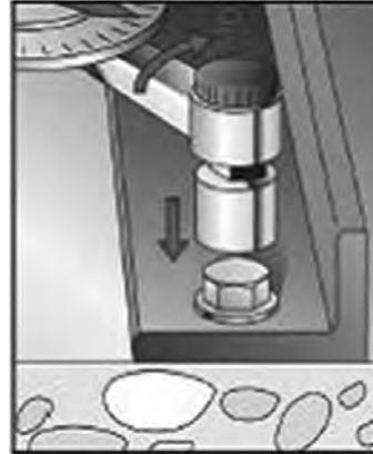
8. Sicherstellen, dass Sechskantmutter mit 110 Nm angezogen sind.
