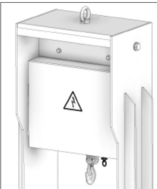
1. Warnschild „Warnung vor elektrischer Spannung“ ⑰ gut sichtbar an der Abdeckhaube ⑭ anbringen.
