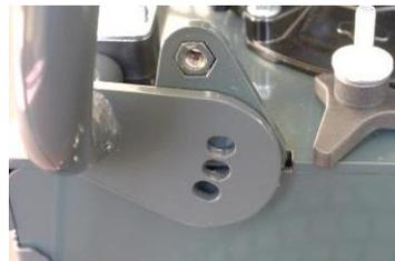
Die Sterngriffschraube (2) aus dem Positionshalter (1) herausdrehen. Den Lenkbügel (3) nun langsam aufrichten bis die passende Bedienhöhe erreicht ist. Dabei auf die Bowdenzüge (Kabel) achten. Die Sterngriffschraube (2) in den Positionshalter (2) eindrehen.
