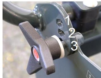
Die Sterngriffschraube (2) herausdrehen. Mit den drei vorgegebenen Bohrlöchern im Positionshalter (1) kann die Höhe des Lenkbügels gewählt werden. Die Sterngriffschraube (2) in der gewünschten Höhe wieder eindrehen.
