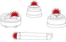
**6.** Wenn bei allen Warnmeldern die rote LED blinkt, sind sie vernetzt und der "Lernmodus" kann ausgeschaltet werden und die Installation beginnen.
