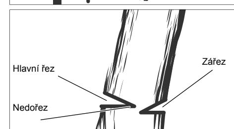
**VAROVÁNÍ!** Hlavní řez nikdy neprořežávejte až k zárezu. Nedodrží, tedy čast dřeva mezi zárezem a hlavním řezem, rídí pád stromu. Nikdy se nestavte přímo za kmen padajícího stromu. Hrozí nebezpečí, že kmen praskne a vymřtí se proti vám.
