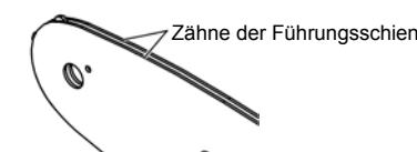
Eine Schiene mit einer der folgenden Verschleißerscheinungen sollte ersetzt werden:
