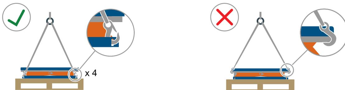
Bild 13 Heben Sie die Sicherheitsleiste nicht an.
