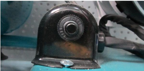
Abb. 7: Motorschutzschalter
