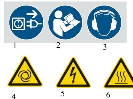
Abb. 1: Gebotszeichen (1 Netzstecker ziehen / 2 Gebrauchsanweisung beachten / 3 Gehörschutz tragen) | Warnzeichen (4 Warnung vor automatischem Anlauf / 5 Warnung vor gefährlicher elektrischer Spannung / 6 Warnung vor Heißer Oberfläche)
