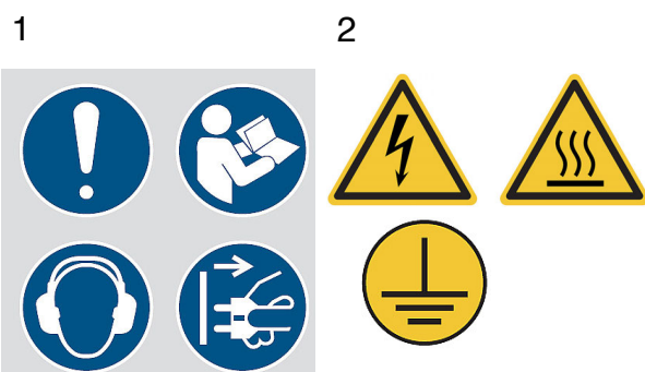
Abb. 1: Sicherheitssymbole am Kompressor: 1 Gebotszeichen: allgemeines Gebotszeichen, Gebrauchsanweisung lesen, Gehörschutz tragen, Netzstecker ziehen | 2 Warnzeichen: Warnung vor elektrischer Spannung, Warnung vor heißer Oberfläche, Erdung
