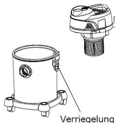
Abb. 13: Öffnen des Schmutzbehälters
