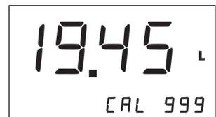
Taste „Mode“: Bestätigung des angezeigten Kalibrierfaktors und Wechsel zurück in den **Abgabemodus**.
