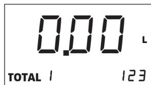
Eine längere Betätigung löscht den aktiven Teilmengen-Totalisator. Der Gesamt-Totalisator kann nicht gelöscht werden.
