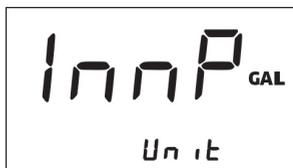
Taste „Mode“: Bestätigen der angezeigten Volumen-Maßeinheit und Wechsel zur **Auswahl Zählertyp**.
