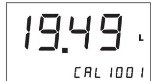
Taste „Licht“: Verminderung des Kalibrierfaktors um 1, Verminderung der angezeigten Abgabemenge pro Umdrehung des Turbinenrads um 1/1000. Bei gehaltener Taste erhöht sich die Einstellgeschwindigkeit.
