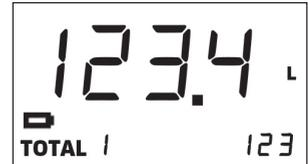
Wenn nur das Batteriesymbol blinkend auf dem Display erscheint, ist der Wechsel der Batterien erforderlich, bevor der Zähler wieder benutzt werden kann.
