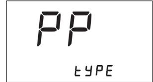
Taste „Reset“: Wechsel zwischen den Kennlinien für die PP Messkammer und die PVDF Messkammer.
