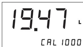
4. Anpassen des Kalibrierfaktors, bis die angezeigte Menge der abgegebenen Menge im Messgefäß entspricht.
