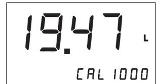
Taste „Reset“: Erhöhung des Kalibrierfaktors um 1, Erhöhung der angezeigten Abgabemenge pro Umdrehung des Turbinenrads um 1/1000. Bei gehaltener Taste erhöht sich die Einstellgeschwindigkeit.
