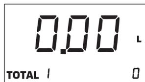
Taste „Mode“: Eine kurze Betätigung wechselt den angezeigten Teilmengen-Totalisator (TOTAL 1 – TOTAL 8) bzw. Gesamt-Totalisator (TOTAL).
