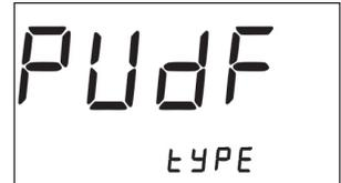
Taste „Mode“: Bestätigen der angezeigten Kennlinie und Wechsel zur **Kalibrierung**.
