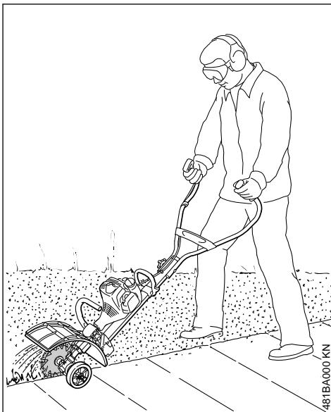
Das MultiWerkzeug Kantenschneider FC-MM dient zum scharfkantigen Beschneiden von Grünflächenrändern. Mit diesem Gerät können fast alle Gras-, und Unkrautarten oder Grünpflanzen geschnitten werden.
