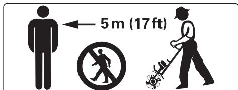
La machine peut projeter des objets à une grande distance de l'aire de travail. C'est pourquoi, à part l'utilisateur, personne ne doit se trouver dans un rayon de 5 m de la machine en marche. Respecter aussi cette distance par rapport à des véhicules, des vitres etc. – **risque de dégâts matériels !** Même à une distance de plus de 5 m, des objets projetés peuvent encore présenter des risques.
