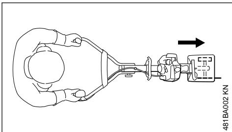
Con il motore Multi dotato del tagliabordi FC-MM si lavora avanzando.
