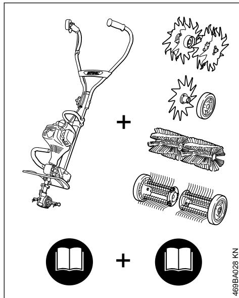
Le MultiSystème STIHL offre la possibilité de combiner différents moteurs MultiSystème et outils MultiSystème pour composer une machine. Dans la présente Notice d'emploi, l'ensemble – en ordre de marche – d'un moteur MultiSystème **et** d'un outil MultiSystème est dénommé machine ou dispositif à moteur.
