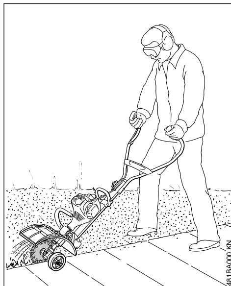
Het multigereedschap kantensnijder FC-MM dient voor het recht afsnijden van gazonranden. Met dit apparaat kunnen praktisch alle gras-, onkruidsoorten of planten worden afgesneden.
