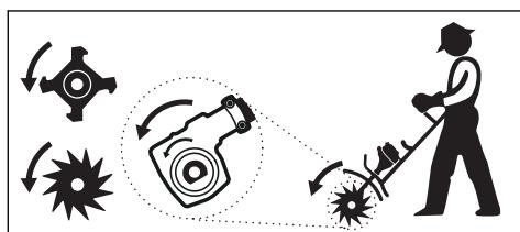
Les flèches marquées sur les couronnes de couteaux indiquent le sens de rotation. Les flèches marquées sur les couronnes de couteaux doivent être orientées dans le même sens que les flèches marquées sur le réducteur.
