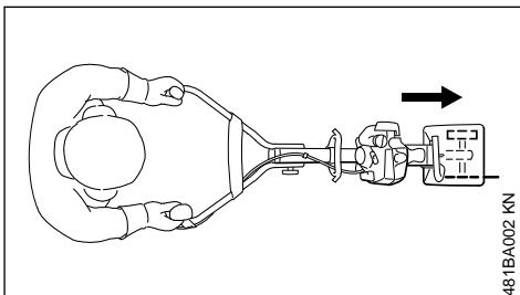
Mit dem MultiMotor mit Kantenschneider FC-MM wird vorwärts gearbeitet.
