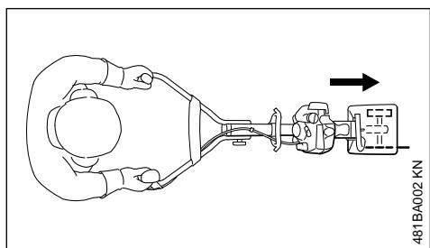
Met de multimotor met kantensnijmes FC-MM wordt in voorwaartse richting gewerkt.
