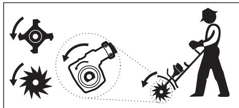
Le frecce sulle zappe indicano il senso di rotazione. Le frecce sulle zappe devono indicare la stessa direzione delle frecce sul riduttore.
