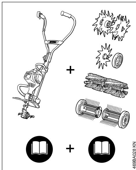
Beim STIHL MultiSystem werden unterschiedliche MultiMotoren und MultiWerkzeuge zu einem Motorgerät zusammengeführt. Die funktionsfähige Einheit von MultiMotor **und** MultiWerkzeug wird in dieser Gebrauchsanleitung Motorgerät genannt.
