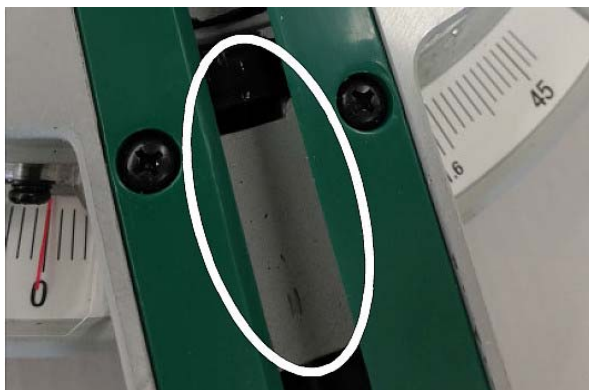
Abb. 15: Beschädigung der Säge wegen falscher Tiefeneinstellung
