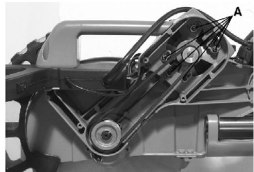
Abb. 18: Motorschrauben lösen
