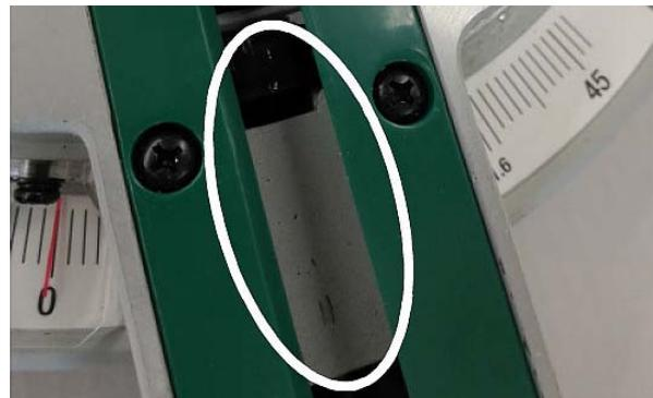
Abb. 10: Beschädigung der Säge wegen falscher Tiefeneinstellung
