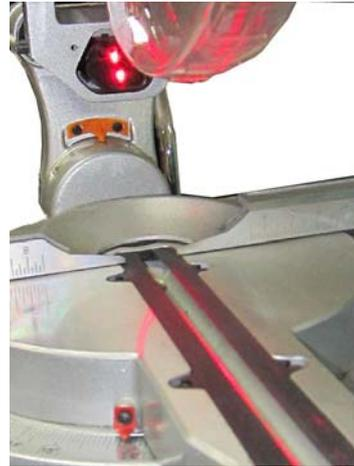
Abb. 4: Laser zur Markierung der Schnittlinie
