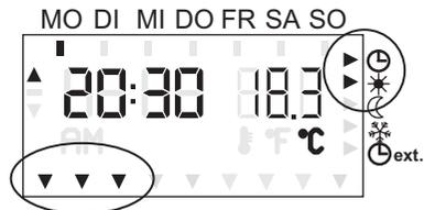
Mit den Dreiecken am unteren Displayrand wird die aktuelle Aussteuerung des Spannungsausganges (Phasenanschnitt) für die Deckenventilatoren angezeigt.
