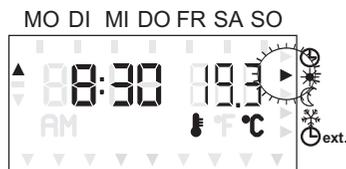
Durch Drücken der Tasten + und – kann der Temperaturmodus gewechselt werden.
