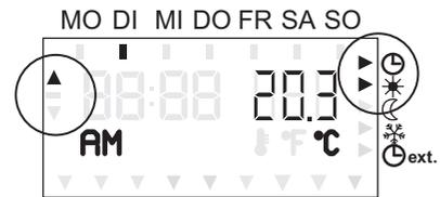
Mit den **+** und **-** Tasten können Werte bzw. Funktionen geändert werden.
