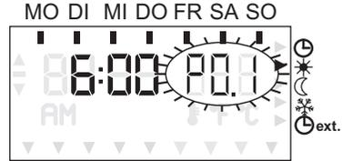
Im Display erscheint die Programmnummer **P01**, die zugehörige Uhrzeit, die Wochentage, die entsprechende Temperaturstufe (Tagtemperatur, Nachttemperatur oder Ferientemperatur) welche durch den Indikator rechts angezeigt wird.
