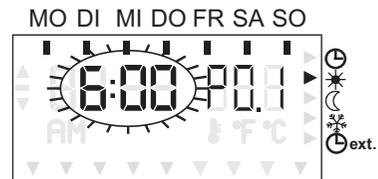
Durch Drücken der Tasten + und – kann der Schaltzeitpunkt der Uhr in 10 Minuten Schritten verändert werden.
