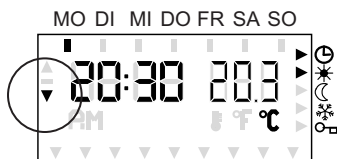
Anzeige bei geschaltetem Ausgang „Kühlen“
