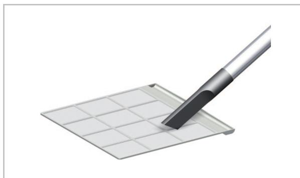
Abb. 35: Reinigung mit dem Staubsauger
