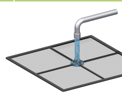
6 Reinigung mit lauwarmen Wasser
