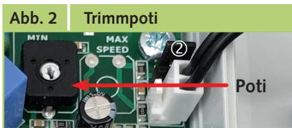
Die Spannung darf nur soweit abgesenkt werden, dass der (die) Ventilator(en) nach einem Stillstand einwandfrei wieder anlaufen können.
