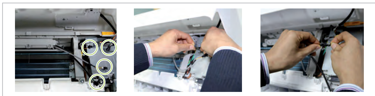
Abb. 7: Mit der Display- und Steuerplatine verbinden
