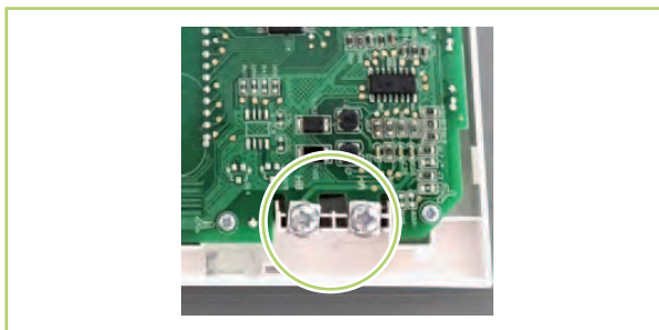
Abb. 9: Kontakte HA und HB der Fernbedienung
