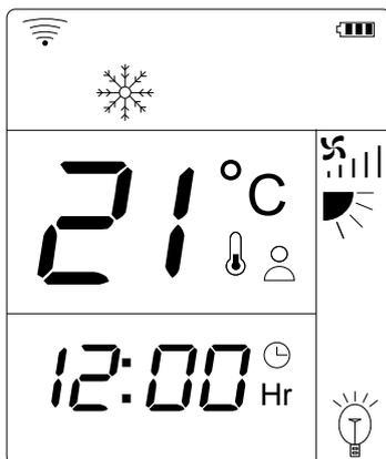
Betätigen Sie ein- bzw. mehrmals die Taste „Mode“ um in den Kühlmodus zu wechseln. Nutzen Sie diesen Modus um die Raumluft auf die gewünschte Solltemperatur abzukühlen.
