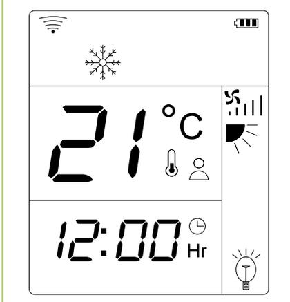
Betätigen Sie ein- bzw. mehrmals die Taste „Mode“ um in den Kühlmodus zu wechseln. Nutzen Sie diesen Modus um die Raumluft auf die gewünschte Solltemperatur abzukühlen.
