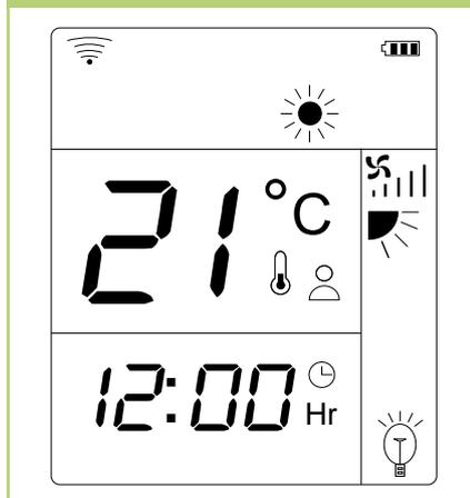
Betätigen Sie ein- bzw. mehrmals die Taste „Mode“ um in den Heizmodus zu wechseln. Nutzen Sie diesen Modus um die Raumluft auf die gewünschte Solltemperatur zu erwärmen. Voraussetzung hierfür ist ein entsprechendes Vorhandensein im Heizleitersystem..
