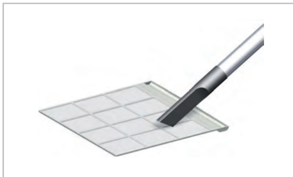
Abb. 19: Reinigung mit dem Staubsauger
