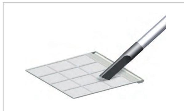
Abb. 19: Reinigung mit dem Staubsauger
