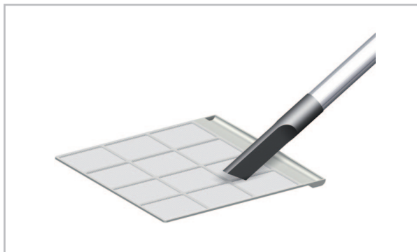
Abb. 19: Reinigung mit dem Staubsauger
