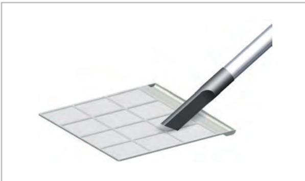
Abb. 24: Reinigung mit dem Staubsauger
