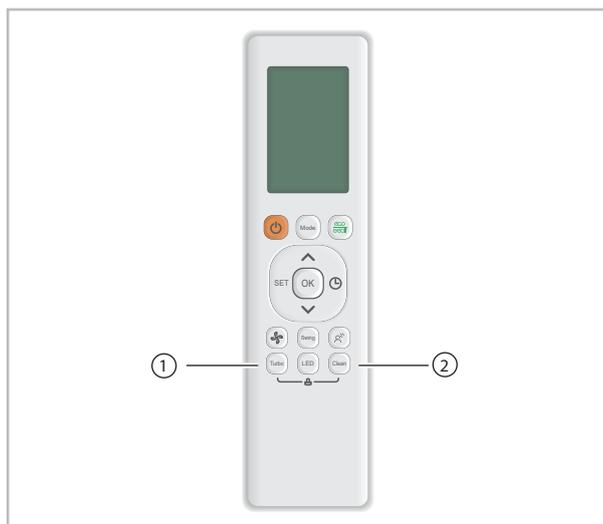
Abb. 17: Tastensperre aktivieren / deaktivieren
