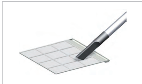
Abb. 20: Reinigung mit dem Staubsauger
