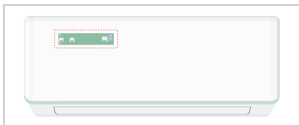
Abb. 32: Eibauposition der Adapterplatine
