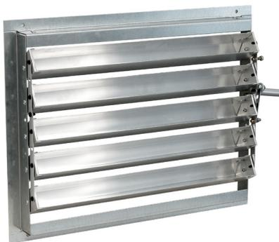
Über die Injektionsjalousie wird die Zuluft optimal eingeblasen. Die Stellung der Luftlenklamellen beeinflusst dabei die Luftgeschwindigkeit und die Ausblastemperatur des Gesamtluftstromes. Mit dieser Technik wird eine größere Wurfweite und ein schnelles Aufheizen der zu temperierenden Räume erzielt. Das Ansaugen der schon erwärmten Raumluft hat zur Folge, dass verschieden temperierte Luftschichten erst gar nicht entstehen können. Es entsteht eine gleichmäßig verteilte Wärme im Raum.
