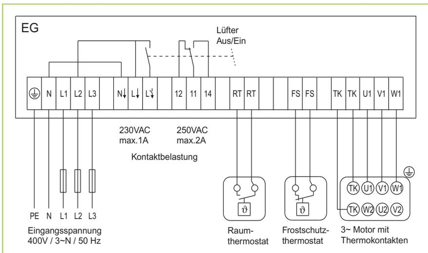
5-stufige Schaltgeräte in 400 V / 50 Hz, Drehstromausführung mit Betriebsmeldeleuchte. Der Motorschutz erfolgt durch den Anschluss von Thermokontakten.
