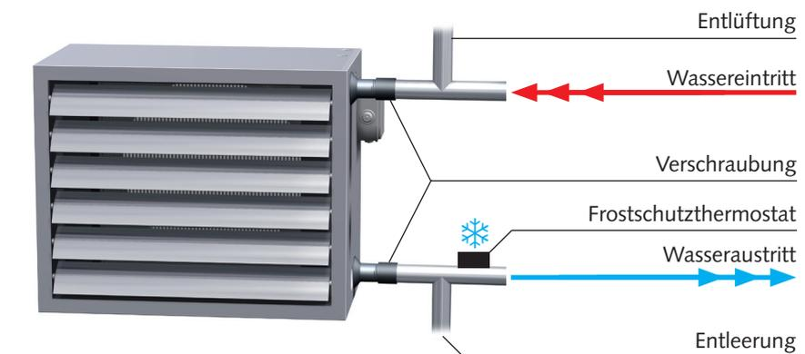
Fall Wasser im Wärmetauscher befinden. Das Restwasser ist mit Druckluft auszublasen.
