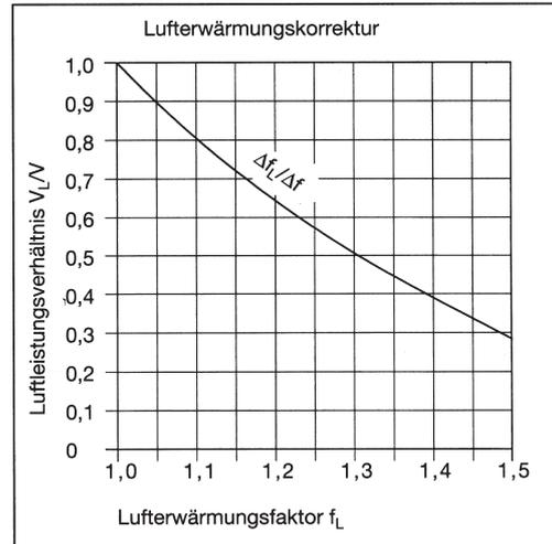
Ermittlung von Wärmeleistung und Luftmenge bei Verwendung von Zubehörartikeln:
