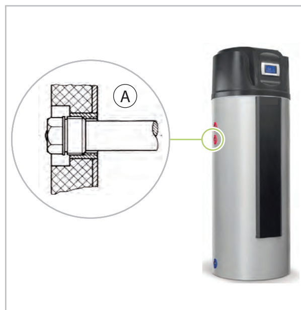
Abb. 4: Austausch der Magnesiumanode
