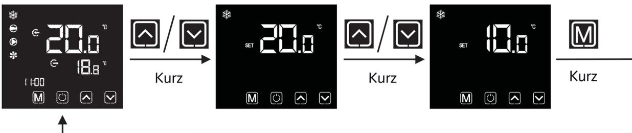
Um den Sollwert für die Rücklauftemperatur einzustellen, drücken Sie im Startbildschirm die - Taste oder die - Taste kurz. Die Anzeige blinkt. Nun lässt sich mit den selben Tasten der Sollwert in 0,5 Schritten verändern. Ist die gewünschte Temperatur eingestellt, bestätigen Sie die Eingabe mit der - Taste. Der eingestellte Wert wird gespeichert und Sie befinden sich wieder im Startbildschirm.
