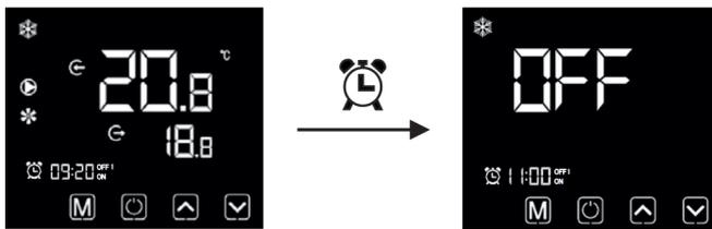
Ist die Anlage aktiviert und die eingestellte Uhrzeit eines Ausschaltpunktes (OFF1, OFF2) ist erreicht, deaktiviert sich die Anlage selbstständig.
