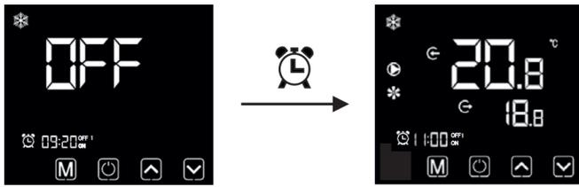
Ist die Anlage deaktiviert und die eingestellte Uhrzeit eines Einschaltpunktes (ON1, ON2) ist erreicht, aktiviert sich die Anlage selbstständig. Sie führt dann den Betrieb mit den Einstellungen vor der Deaktivierung fort.
