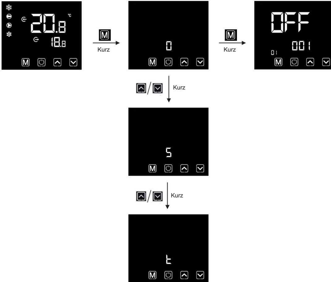
Um die Betriebsparameter anzuzeigen drücken Sie im Startbildschirm kurz die **M**-Taste. Hier können nun Sensorwerte und andere Betriebszustände abgefragt werden. Die Navigation zwischen den verschiedenen Betriebsparametern erfolgt mithilfe der **↑**-Taste und der **↓**-Taste.
