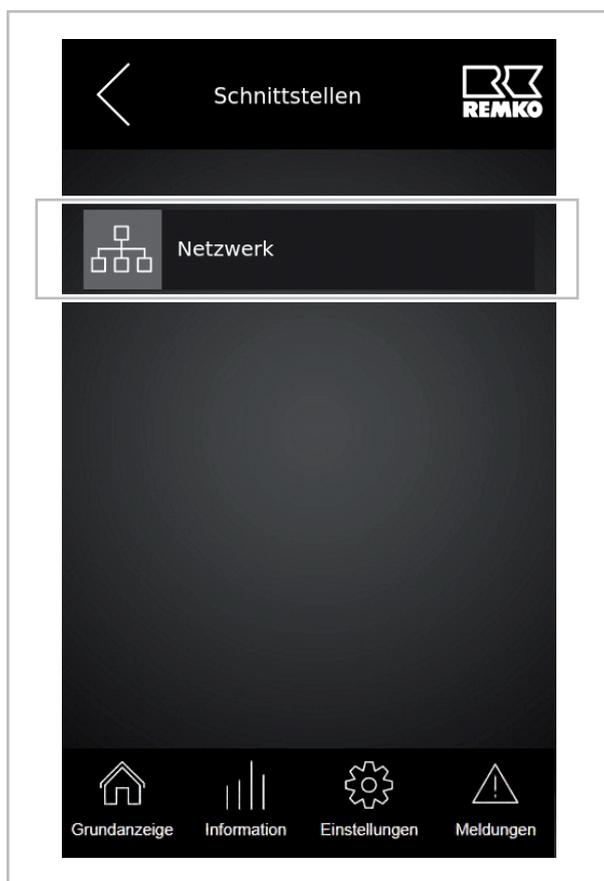
Hier finden Sie die Parameter die zur W-LAN Funktion vorhanden sind. Ist die REMKO Wärmepumpe über ein LAN-Kabel mit dem Router verbunden benötigen Sie nur noch die IP-Adresse die unter "Status" angezeigt wird.
