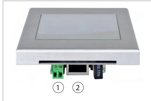
Abb. 2: Anschlüsse der Fernbedienung
