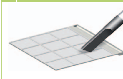
3 Reinigung mit dem Staubsauger
